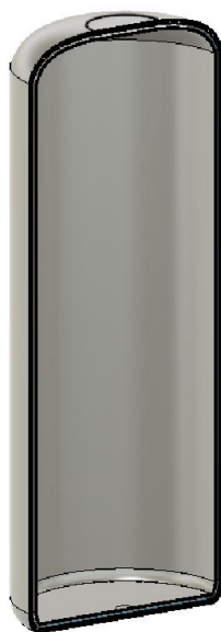
3.3-сурет – Криокамераның ішкі құрылысы
